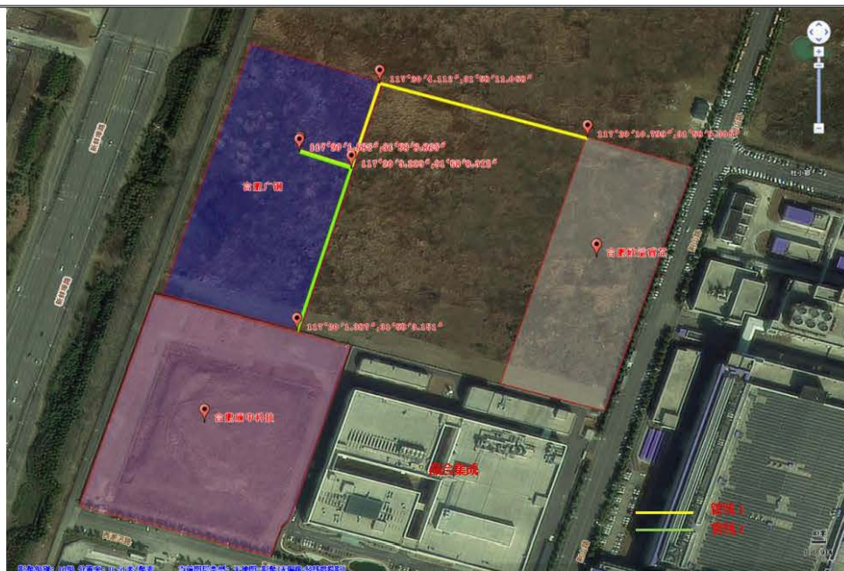
建设项目管道走向示意图
