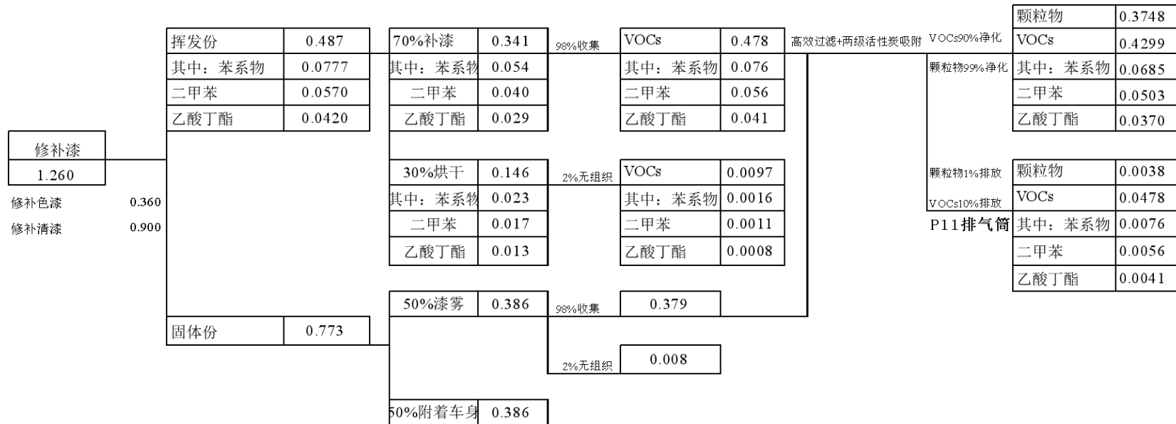
图 3.2-5. 涂装车间一色漆、清漆修补（小修补）漆料平衡图 单位：t/a
