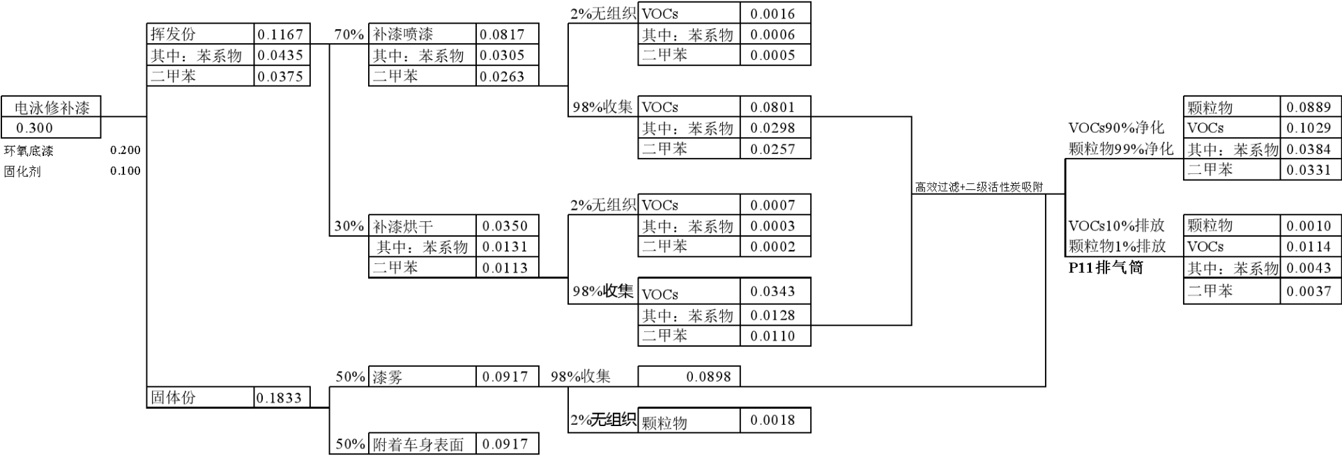
图 3.2-2. 涂装车间—电泳修补工段漆料平衡图 单位：t/a
