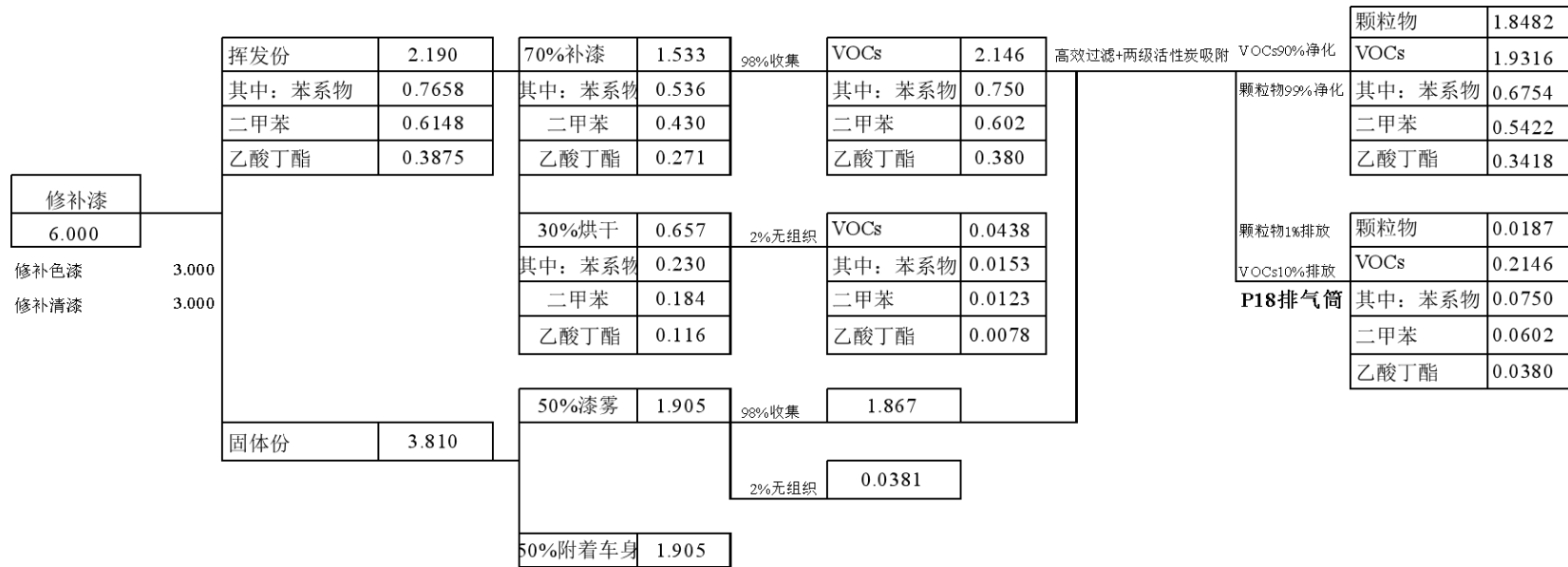
图 3.2-6. 总装车间—修补漆料平衡图 单位：t/a
